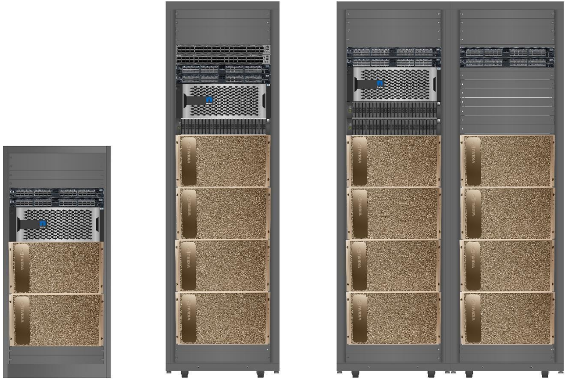
图 1) 采用 NVIDIA DGX A100 系统的 NetApp ONTAP AI 系列。
