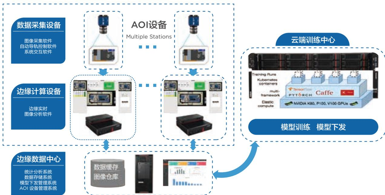
联想视觉技术品质检测方案系统架构图
